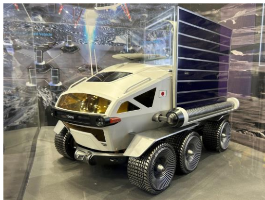
図表 7-24 トヨタ自動車が開発する 与圧ローバーの完成予想模型
